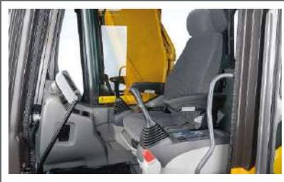
La cabina FOPS/ROPS, a través de un meticuloso análisis, optimizo la estructura de acero y el rendimiento de sellado de la cabina; su fuerza es 5 veces mayor que la cabina general. El rendimiento de seguridad es extremadamente alto y mientras tanto el ruido de la cabina se reduce en 3-5db, lo que hace que la operación sea más cómoda.
